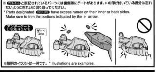
アンダーゲートの切り取りかた Trimming under-gate material
